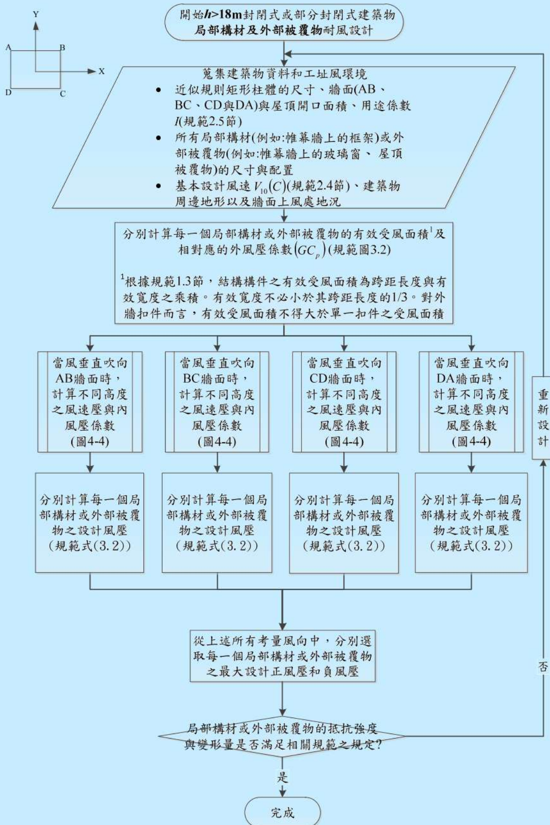
圖 4-5 高度超過 18 公尺封閉式或部分封閉式建築物之局部構材及外部被覆耐風設計流程圖
